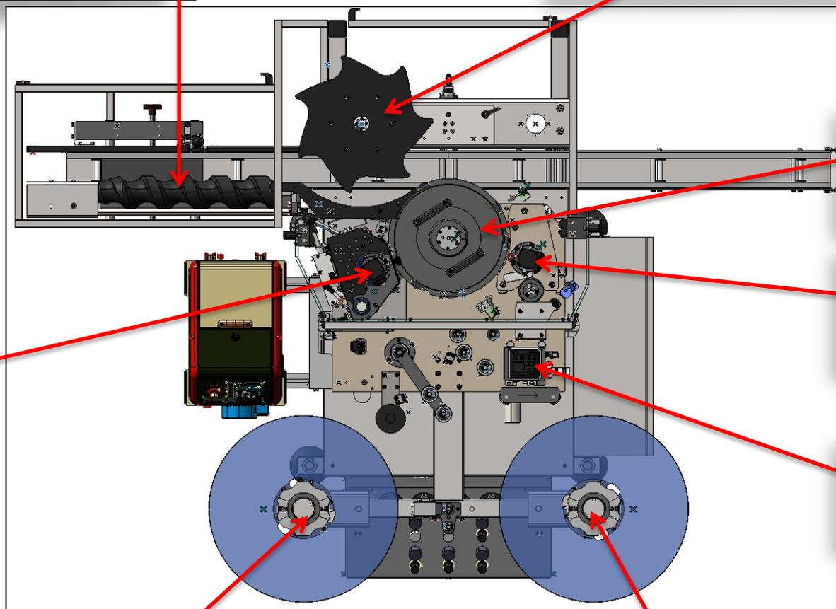
**Приводной вакуумный барабан**
