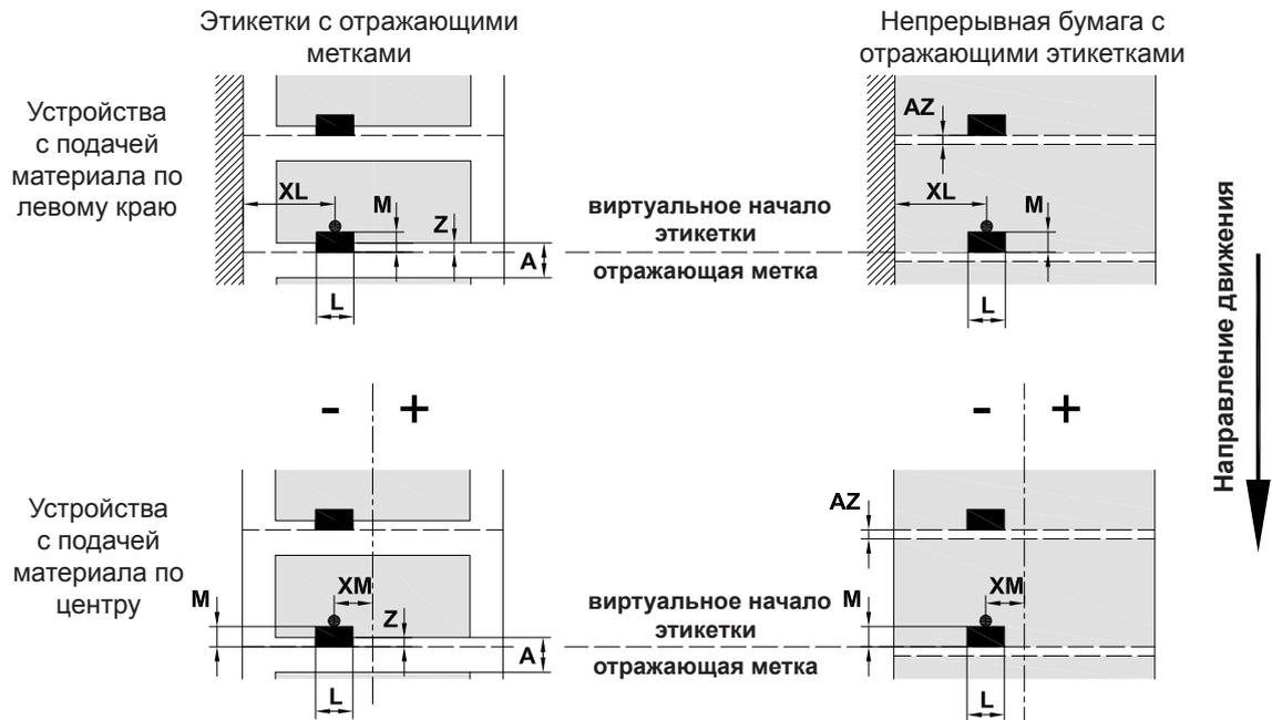
Рис. 28 Размеры отражающих меток
