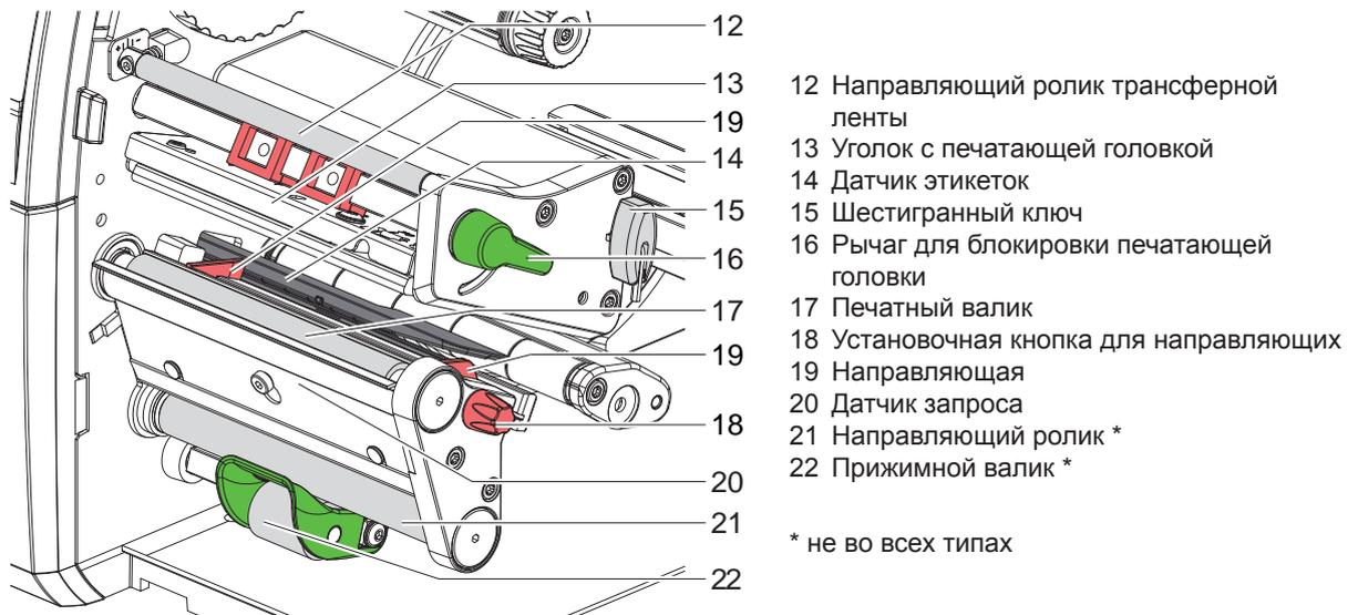
Рис. 3 Печатный узел - устройства с подачей материала по центру
