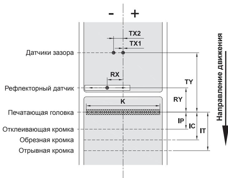
Рис. 24 Размеры устройства
