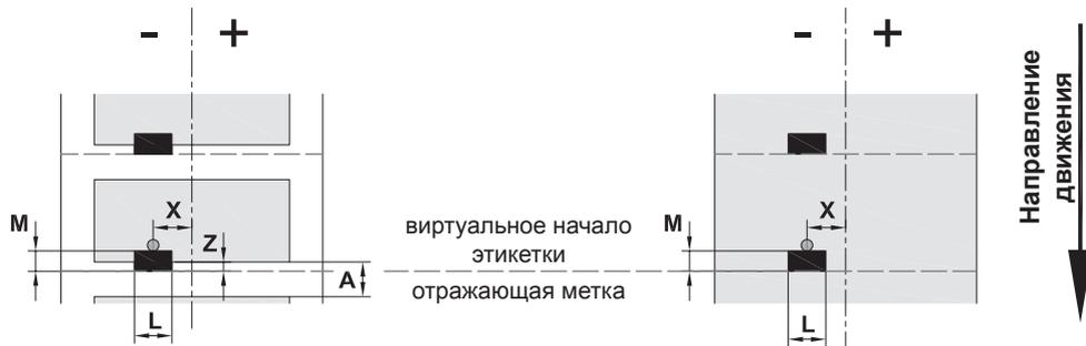
Рис. 25 Размеры отражающих меток
