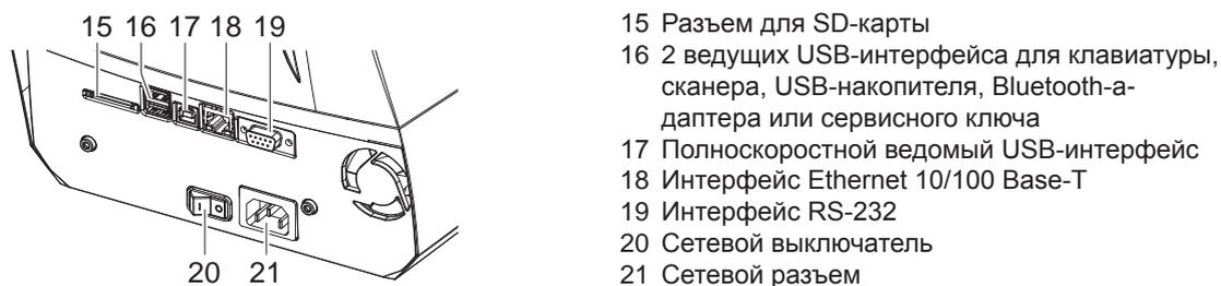
Рис. 3 Подключения
